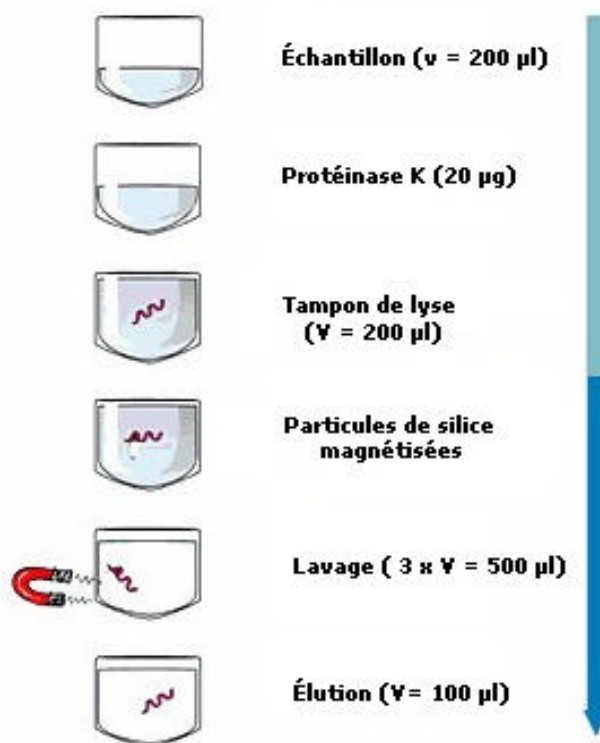
Figure 1. Schéma d'extraction de l'ADN par adsorption sur particules de silice magnétisées (source Roche Applied Science)
